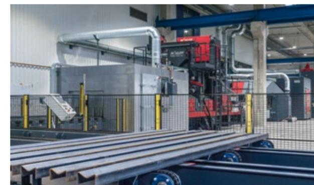
**Erhitzung** der unbehandelten Stahlprofile zur optimalen Vorbereitung auf den Strahlprozess.
