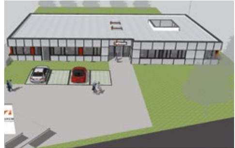
Im Januar 2018 fällt der Startschuss für die Modulmontage des neuen Bürogebäudes der NUKEM Isotopes GmbH in Alzenau. Auf 1.060 m<sup>2</sup> entsteht in nur 4 Monaten Bauzeit ein 2-geschossiges Gebäude, dessen Untergeschoss in Stahlbetonbauweise sich wegen einer starken Hanglage zum Teil unterhalb der Erdoberfläche befindet. Die Fassade besteht aus einer Kombination von WDVS und Metallkassetten. Das Erdgeschoss verfügt über einen Innenhof, auch überbaute Parkplätze sind vorgesehen.
