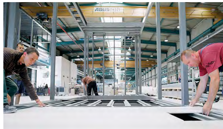
Zum Fertigstellen der Rohdecke werden die Module maschinell gedreht.
