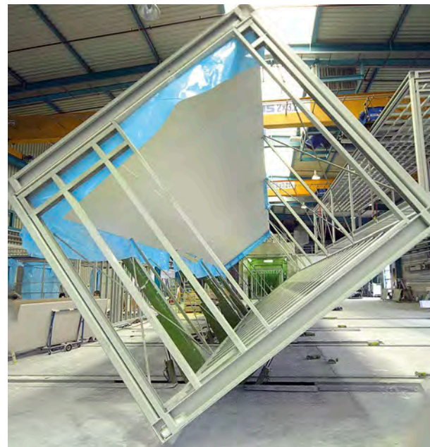
Zum Fertigstellen der Rohdecke werden die Module maschinell gedreht.
